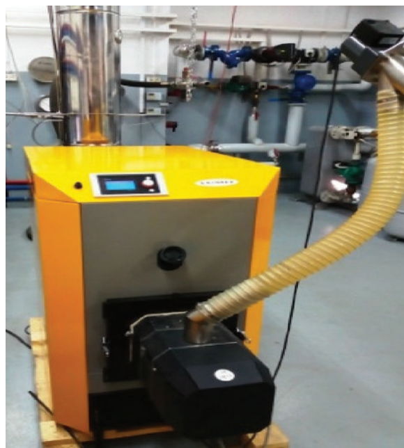
Rys. 1. Kocioł peletowy – badany obiekt Fig. 1. Pellet boiler – tested object
