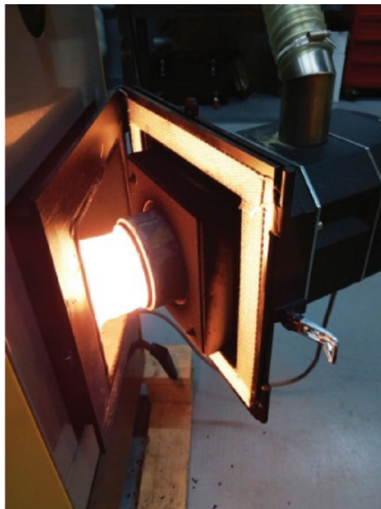
Rys. 2. Pracujący palnik peletowy – badany obiekt Fig. 2. Pellet burner in operation – tested object
