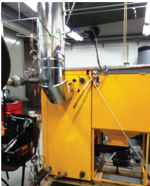
Rys. 4. Obiekt badań – kocioł grzewczy na paliwo stałe Fig. 4. Test facility in the form of a solid fuel heating boiler
