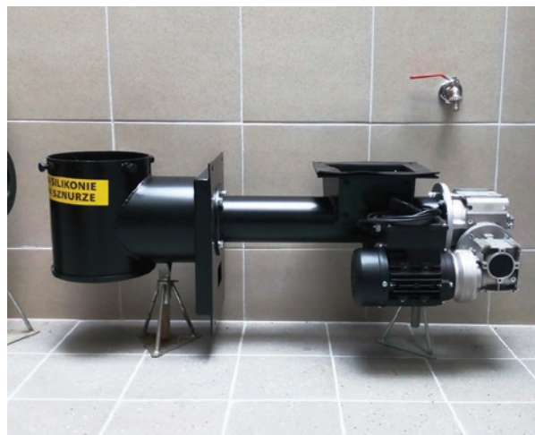
Rys. 2. Palnik retortowy pierwszej generacji Fig. 2. First generation retort burner
