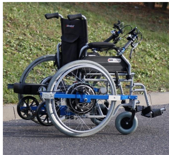
Rys. 18. Prototyp piasty przekładniowej wielobiegowej zamontowanej na wózku inwalidzkim, wykorzystywany w badaniach biomechanicznych [P1]
