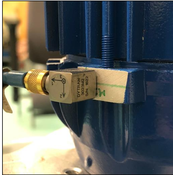
Rys. 5.52. Sposób montażu czujnika DYTRAN 3023M2 na przedniej tarczy łożyskowej silnika BESEL 2SIEK 63-4A2.
