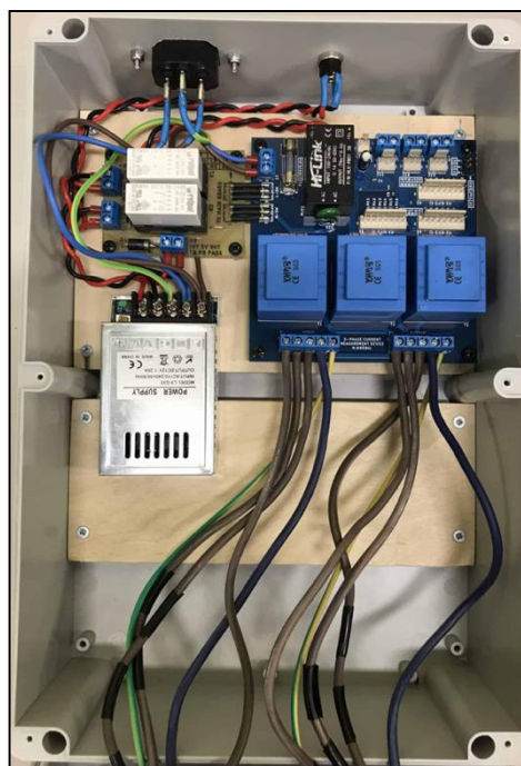
Rys. 5.4. Widok panelu przedniego układu do pomiaru prądów fazowych (a) oraz widok wnętrza układu (b).
