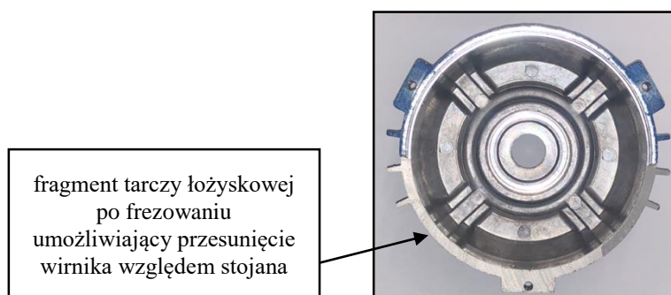
Rys. 5.45. Widok wewnętrznej części tarczy łożyskowej silnika BESEL z widoczną modyfikacją umożliwiającą wprowadzenie niecentryczności.
