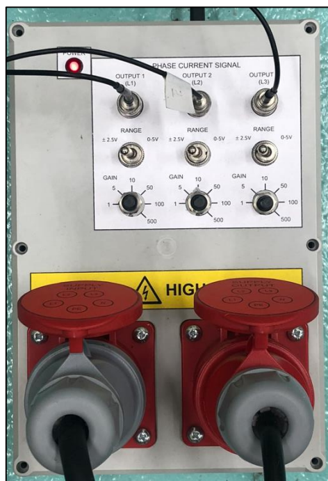
Rys. 5.4. Widok panelu przedniego układu do pomiaru prądów fazowych (a) oraz widok wnętrza układu (b).
