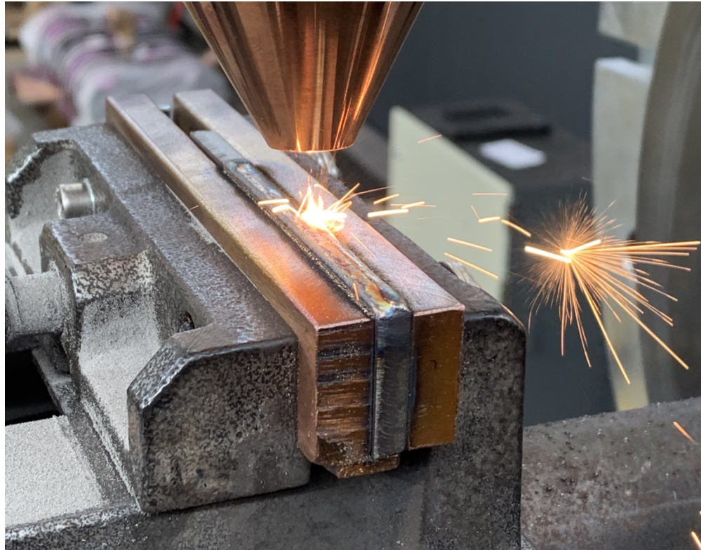
Rys. 4.8. Wizualizacja procesu modyfikacji warstwy wierzchniej z wykorzystaniem lasera
