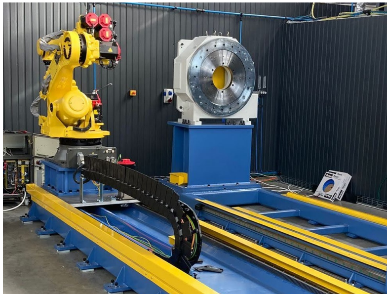
Rys. 4.6. Robot wykorzystany do napawania próbek
