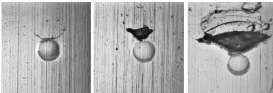
Rys. 2.31. Etapy powstawania spallingu [33]
