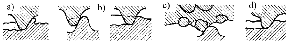
Rys. 2.6. Schemat podstawowych procesów zużycia [58]; a) bruzdowanie, b) ścinanie nierówności, c) ścinanie nierówności ścierniwem, d) odkształcanie plastyczne materiału
