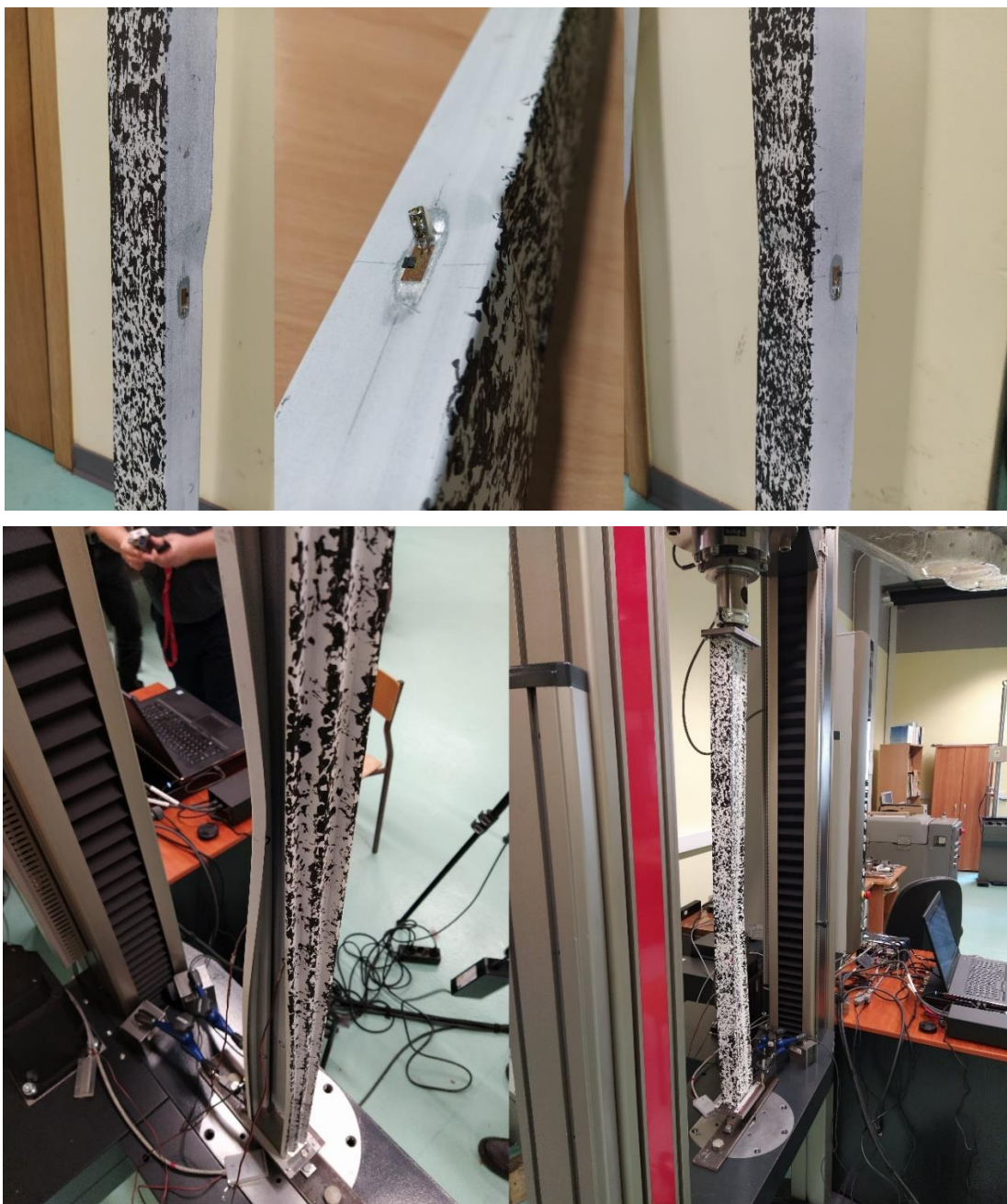
Rysunek 4.7. Formy zniszczenia ściskanych słupów
