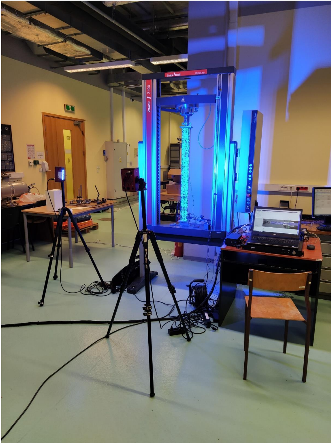
Rysunek 4.14. Stanowisko do badań optycznych (system ARAMIS)
