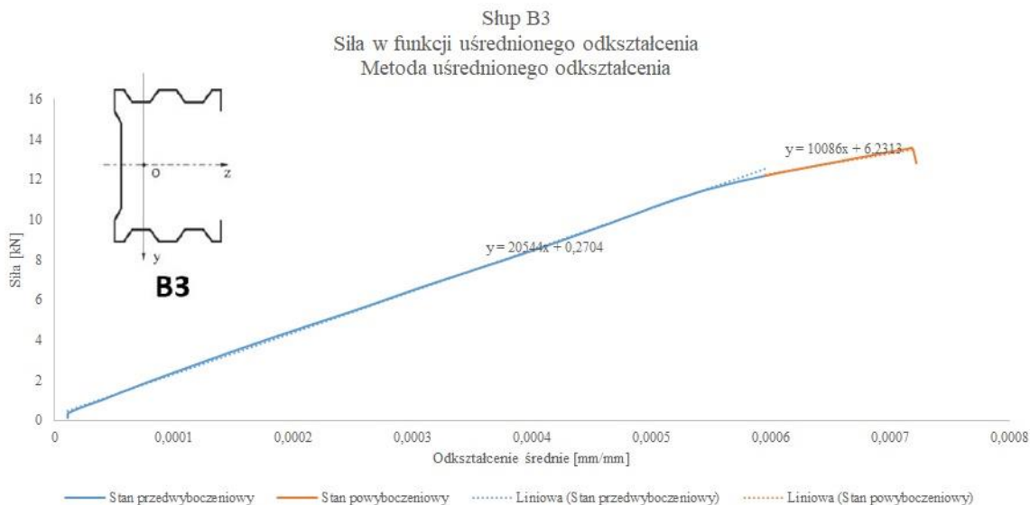
Rysunek 4.8. Zastosowanie metody uśrednionego odkształcenia do wyznaczenia wartości siły krytycznej dla słupa B3
