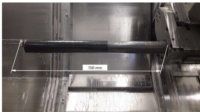
Rys. 29. Oprawka antywibracyjna S-570-3C-70/80-1053-40CR z główką SL-SVLBL-40-16HP [A7]
